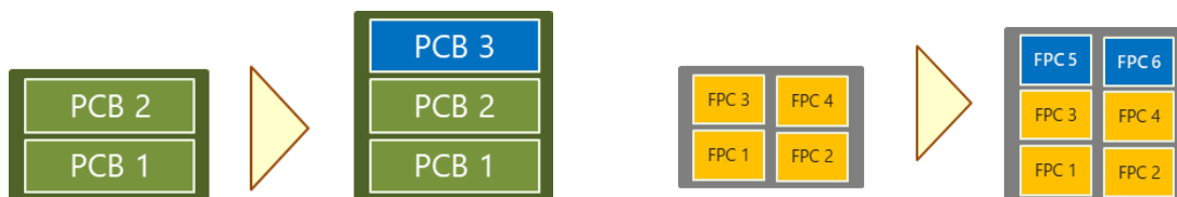
(Bilder 2a und 2b): Doppelspur-Maschinen mit je 330 mm Transportbreite erhöhen die Nutzen- und Trägerkapazität je Spur.
